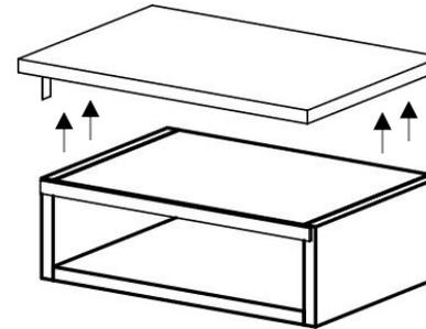
(3) Schrauben der Befestigungswinkel lösen. Anschließend beide Befestigungswinkel um 5/15mm nach außen verschieben und wieder befestigen
